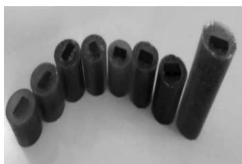
شکل ۷ plug شیلی بیرون آورده شده از قالب
