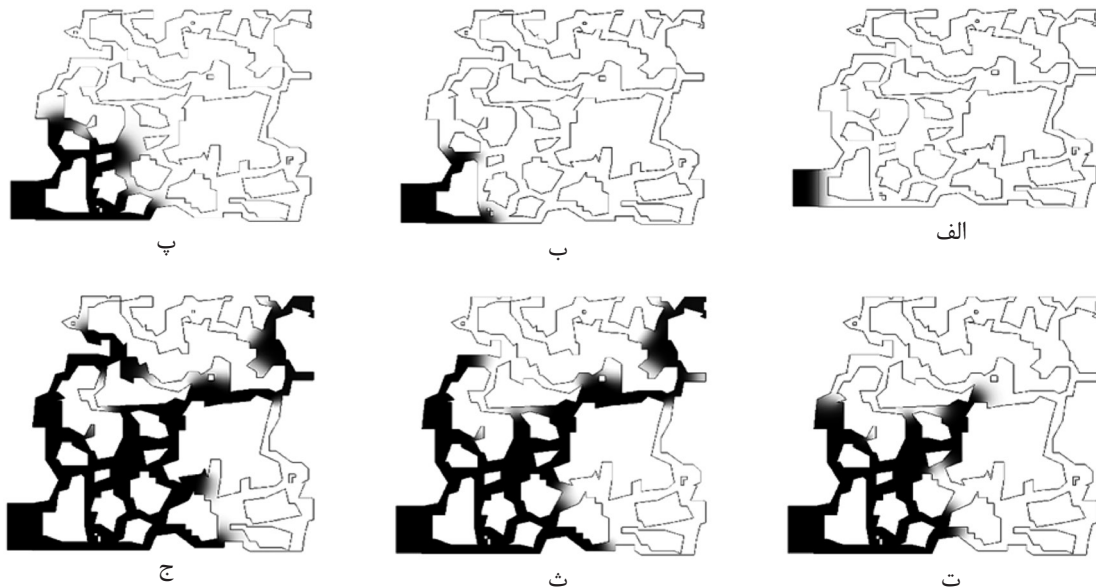
شکل ۵ توزیع غلظت سیالات آب و نفت در مدل ۱ در زمان بدون بعد الف-۰، ب-۰/۱۱، پ-۰/۳۳، ت-۰/۵۵، ث-۰/۹، ج-یک
