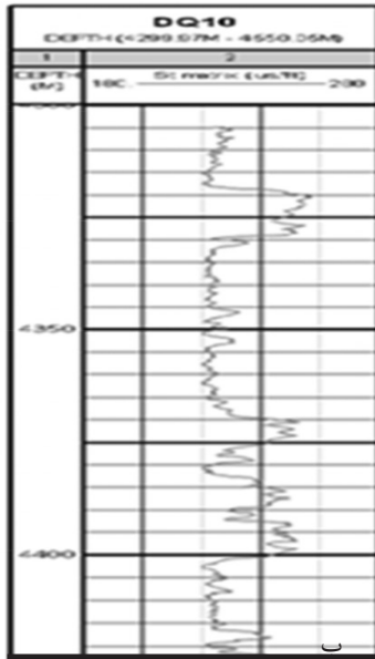
شکل ۵ محاسبه تغییرات کندشدگی موج استونلی در زمینه سنگ به صورت پیوسته.
