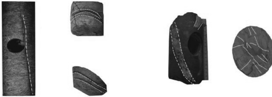
شکل ۱- نمونه‌ای از شکستگی باز (سمت چپ) و شکستگی پر شده از انیدریت و کلسیت (سمت راست) در مغزه‌های میدان مارون
