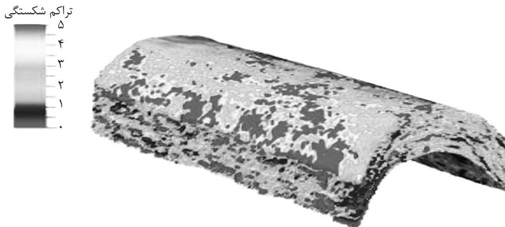
شکل ۶- مدل تراکم شکستگی با استفاده از روش شبکه عصبی و داده نشانگرهای لرزه ای، مدل های زمین شناسی و تراکم شکستگی سه چاه
