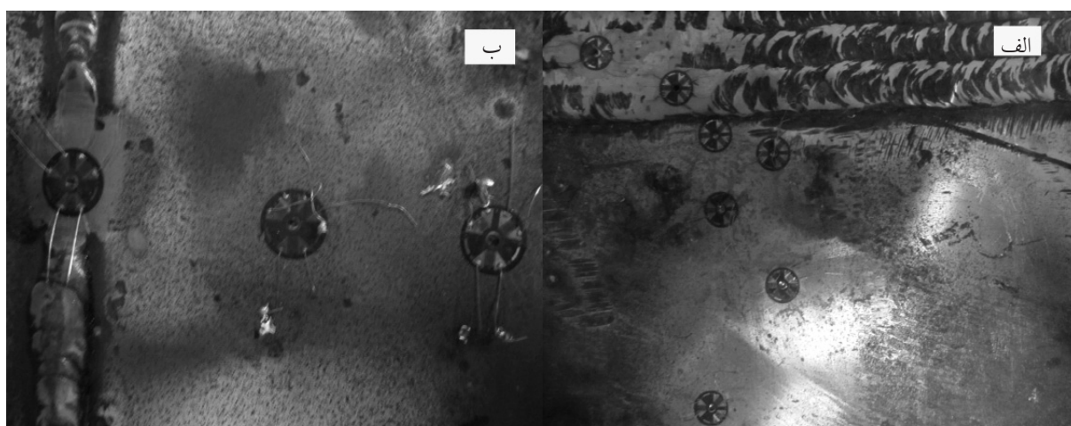
شکل ۳- محل آزمایش کرنش‌سنجی سوراخ، الف) روی سطح خارجی لوله، ب) روی سطح داخلی لوله
