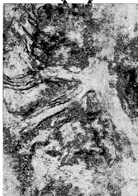
شکل ۵- نقشه ترکیبی مربوط به برش زمانی ۱۸۰۰ میلی ثانیه، (الف). برش زمانی مربوط به نشانگر همدوسی، (ب) برش زمانی مربوط به نشانگر دامنه لحظه‌ای بیشینه و (ج). برش زمانی حاصل از ترکیب نشانگرهای همدوسی و دامنه لحظه‌ای بیشینه
