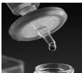
شکل ۲- نحوه فیلتراسیون توسط فیلترهای سرنگی
