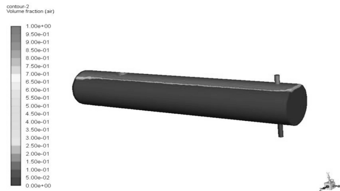
شکل ۹ کانتور کسر حجمی هوا در جداساز با ارتفاع سطح مایع ۹۰٪ و فاصله ۹۰ cm بین خروجی و ورودی
