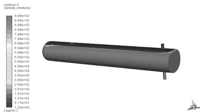
شکل ۱۰ کانتور چگالی مخلوط در جداساز با ارتفاع سطح مایع ۹۰٪ و فاصله ۹۰ cm بین خروجی و ورودی
