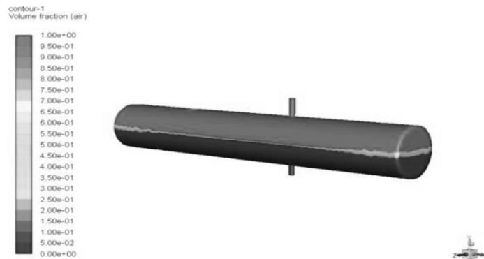
شکل ۵ کانتور کسر حجمی هوا در جداساز در حالت نیمه پر و فاصله ۴۵ cm بین خروجی و ورودی
