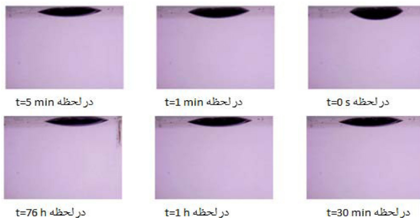
شکل ۷ عکس قطره نفت اول آزاد شده در ساعات مختلف در سیستم نفت خام/شیشه نفت دوست/نانوسیال.
