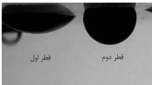
شکل ۵ مقایسه زاویه تماس قطره اول و دوم به ترتیب در حالت انتشار و همرفتی برای آب مقطر.
